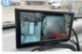
15 화물자동차 충돌재해예방설비 (후방카메라, 인제감지센서)
